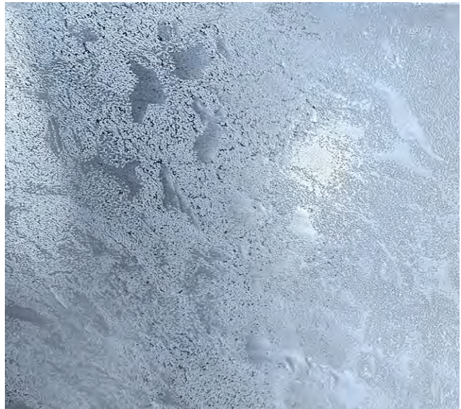
Lederstruktur, hergestellt mittels NIL-Technologie auf einer PET-Folie
