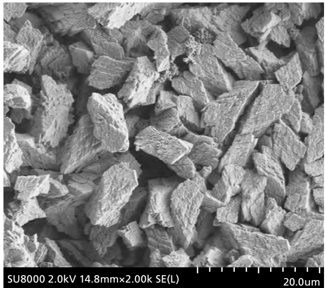
REM-Aufnahme der Kristallstruktur von biogenem Kalkstein (CaCO 3 )
