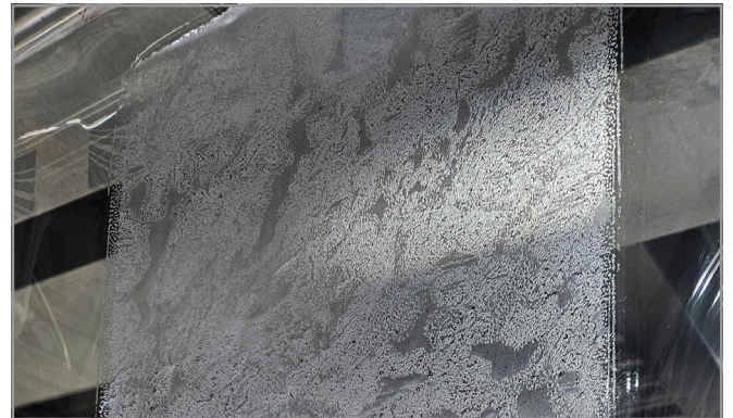
Haptische Oberfläche auf einer Polymerfolie, erzeugt mittels RzR-NIL, die in Kombination mit einem Dekor innerhalb Design-PV als Verkleidung von BIPV-Modulen für Fassaden eingesetzt wird
