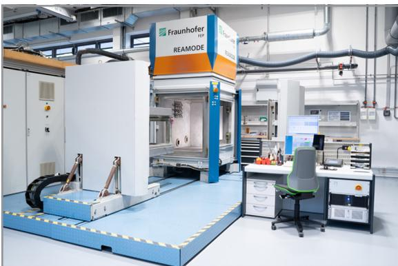
**REAMODE – Versuchsanlage zur Modifizierung von organischen Materialien mit beschleunigten Elektronen**
