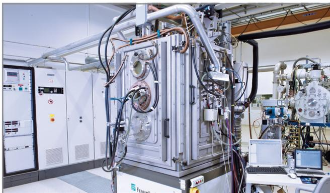
**Batchanlage UNIVERSA des Fraunhofer FEP, mithilfe derer die magnetron-gesputterten Metalloxidschichten hergestellt wurden**
