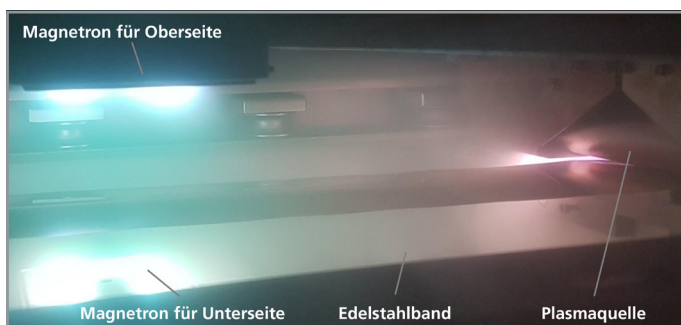
Versuchsaufbau für Katalysatorbeschichtung und Graphen-Synthese
