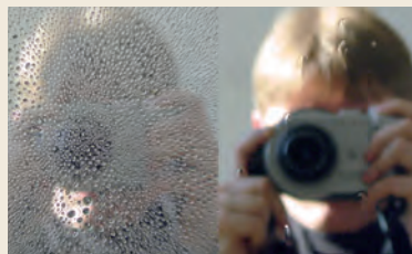
Superhydrophile Titandioxid-Schicht (rechts)
