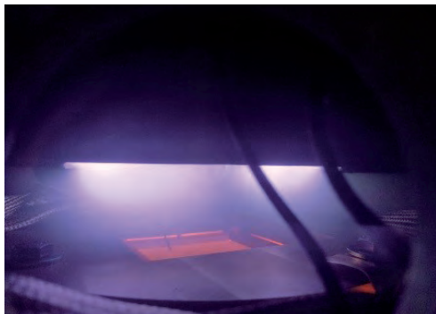
Magnetron-PECVD mit beheiztem Substrat
